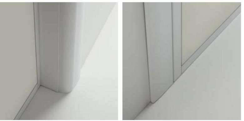
Il lato esterno stipite è arrotondato raggio 25, è telescopico e garantisce una regolabilità di spessore muro di 5 cm.
